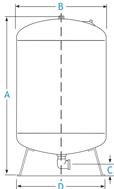
Před montáží nádoby si na obalu zařízení ověřte hodnotu natlakování nádoby z výrobního závodu.
